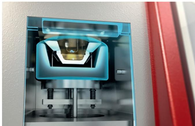
Inflammation à l'intérieur de la chambre fermée en continu, constituée par la coupe de l'échantillon et la plaque de four
