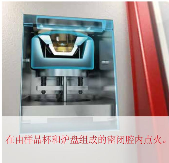
在由样品杯和炉盘组成的密闭腔内点火。
